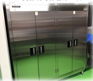
食器消毒保管庫2台
