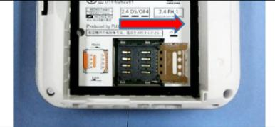
③microSIM をセットし、microSIM 取り付けカバーをロックします
