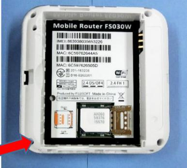
④電池パック端子部と FS030W 本体端子部を合わせ左からスライドさせて取り付けます。
